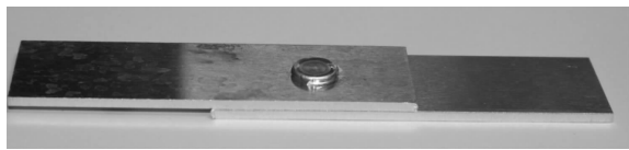
图1 机械变形压力连接点外观
